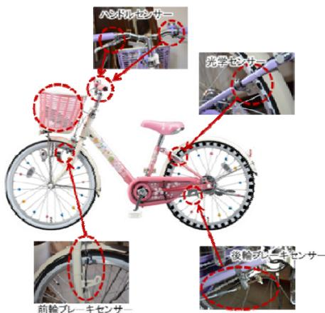
(図10) 計測に用いたセンサー
