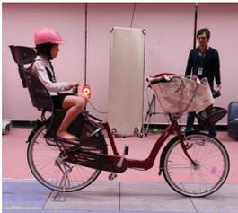
（写真1） モーションキャプチャーシステムを用いた子供の足の動きの計測の様子
