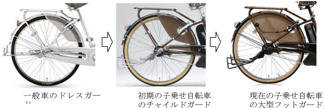
(写真5) 市販自転車（ブリヂストンサイクル社製）の車輪ガードの変遷
