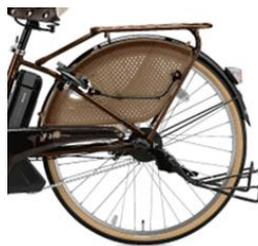
(写真4) 大型フットガードによる車輪のカバー
