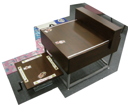
図 3. 子どもの座位時の各種寸法を計測するために開発した測定器
