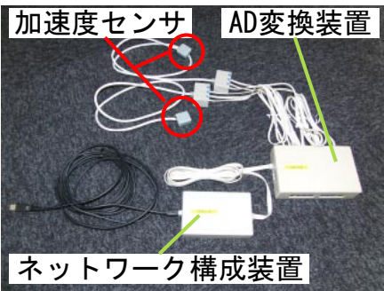
図 2. 多点加速度同時計測システム
