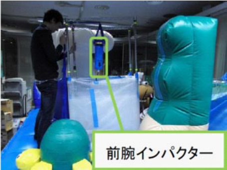
図 5. 前腕インパクター落下実験の様子
