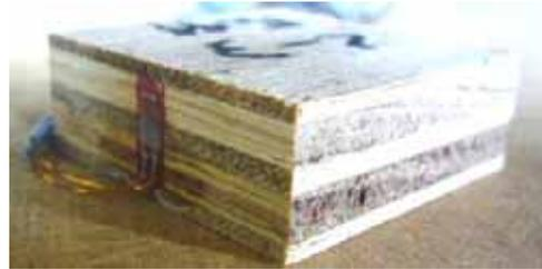
図B.4.7下地台合板の圧縮試験片
