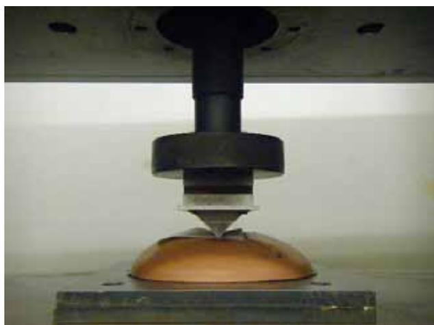
図B.3.1 3歳児ダミーの圧力測定状況
