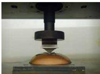
図 3-10 3 歳児ダミーの皮膚の圧力測定
