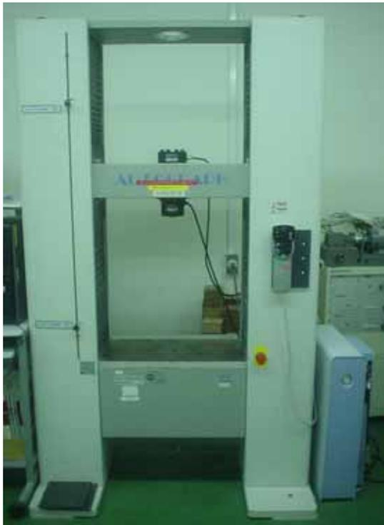
図B.3.5 精密万能試験機
