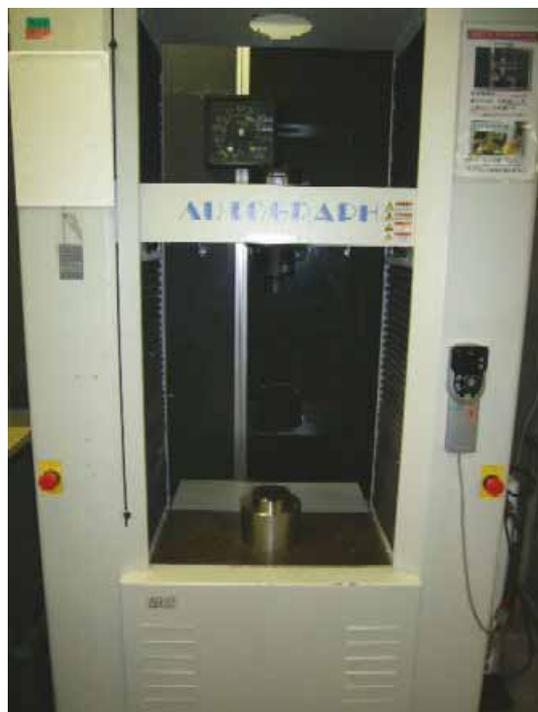
図B.4.8 万能材料試験機
