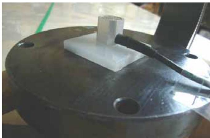
図B.4.3ヘッドモデル加速度計
