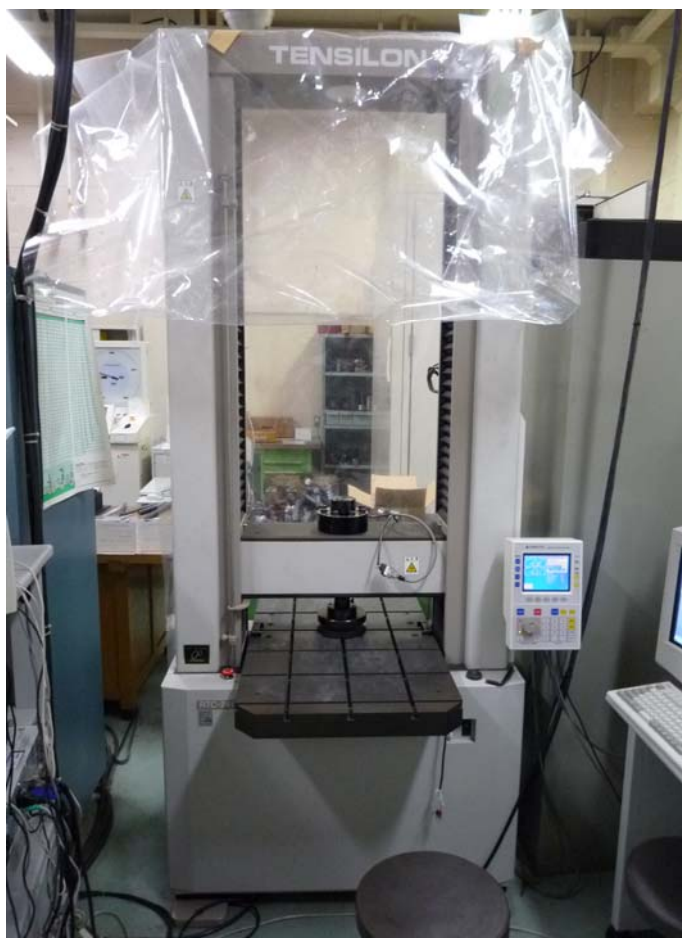
図 B.1.6 静的圧縮試験措置
