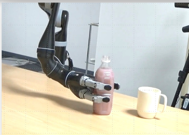
機能属性認識と一般物体認識を利用した生活支援ロボットのプロトタイプ (中京大学・生活空間模擬実験室にて撮影)
